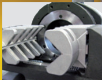
Wendespannbacken zum Bearbeiten von dünn- und dickwandigen Rohren.
