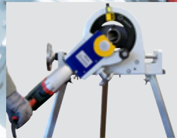
Trennen dünnwandiger Edelstahlrohre und Rohrbögen
