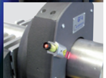
Integrierter Strichlaser-Pointer zur Trennstellen-Markierung auf dem Rohr.
